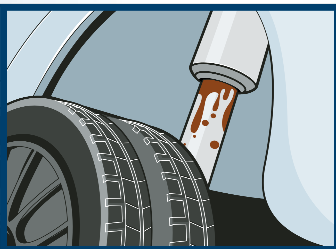
Öl am Stoßdämpfer (Ein leichter Ölfilm dient zur Selbstschmierung der Kolbenstange)
